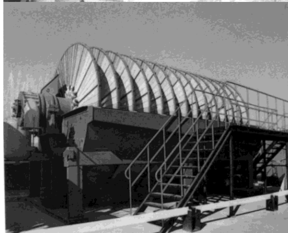
Рис. 4.1.6.2. Диско- вые вакуум-фильтры ДУ-250 Сибирь
