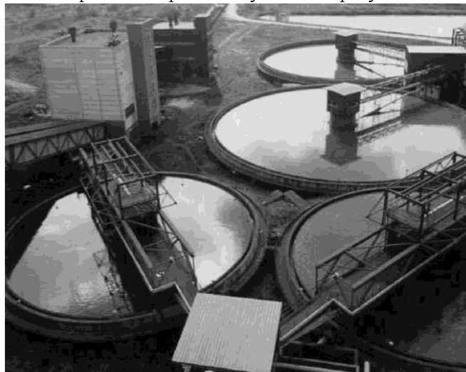
Рис. 4.1.4.2. Сгустители радиальный с периферическим приводом
