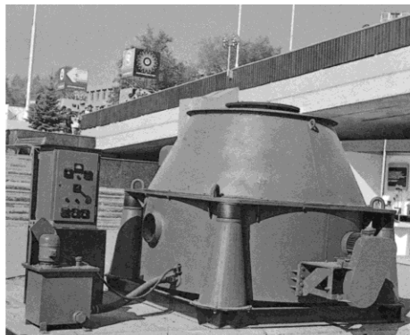
Рис. 4.1.5.1. Центрифуга фильтрующая вертикальная шнековая ФВШ-100С-1
