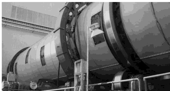
Рис. 4.1.7.2. Барабанная прямоточная сушилка
