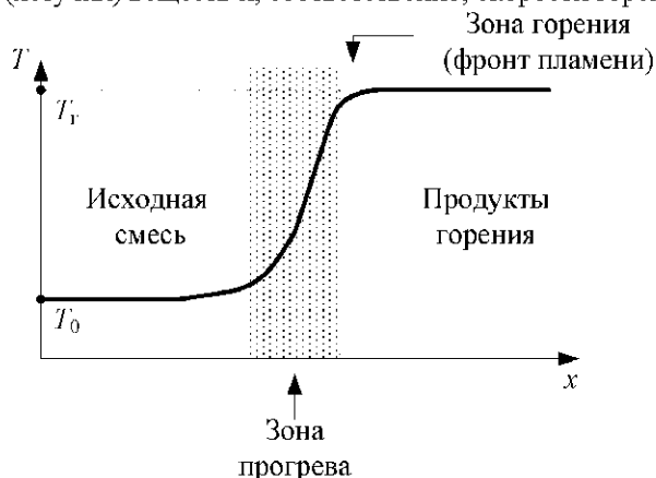
Рис. 4.3. Схема фронта пламени пылевоздушной смеси
