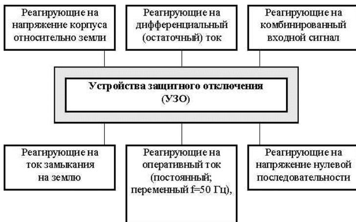
Рисунок 6.1. Классификация УЗО по виду входного сигнала
