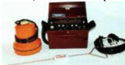
Рис. 1. Акустический прибор поиска пострадавших «Пеленг-1»
