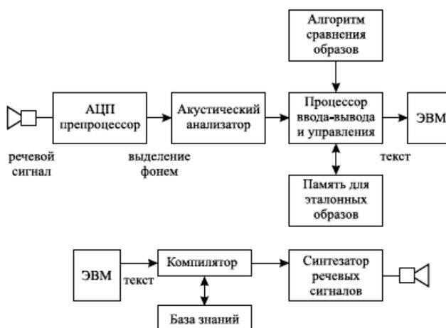
**Рис. 5.3.** Анализатор и синтезатор речевых сообщений в потоке информации
